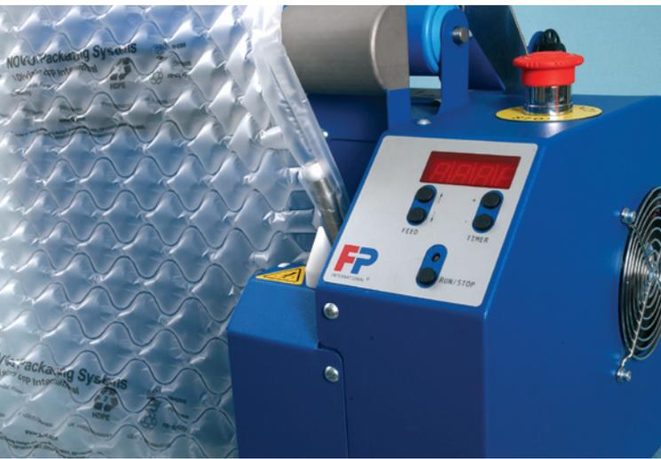
Im Menü der Maschine kann die Länge der zu produzierenden Luftkissen in Metern oder die Zeit zur Herstellung eingestellt werden.
