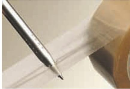
**links:** PP-Träger reißen bei Beschädigungen
